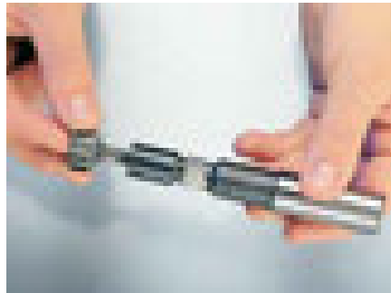
Konusschraube mit Schneidring bis zum Anschlag in den Grundhalter einschrauben.
