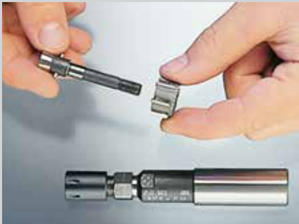
Schneidring auf die Konusschraube schieben (Schneiden voran).
