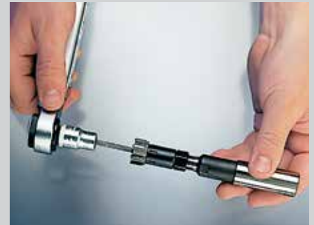
Konusschraube mit Drehmomentschlüssel lt. Richtwerttabelle anziehen.
