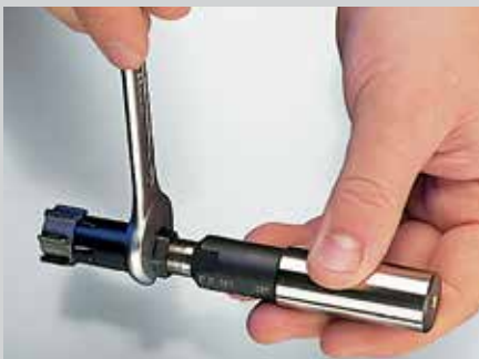
Die Einstellmutter in Pfeilrichtung handfest anziehen.
